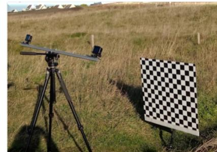
Calibration du dispositif à l'aide d'un damier
